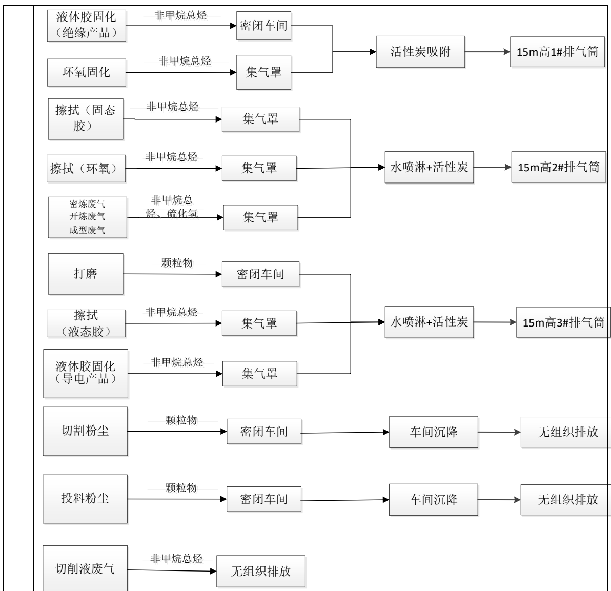
图 4-2 本项目废气收集、处理方式示意图
